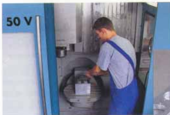
Signifikant nicht allein für die ‚DMU 50 V‘ (sondern eben auch für die ‚DMU...P‘): der Arbeitsraum ist für den Werker überaus offen zugänglich.
