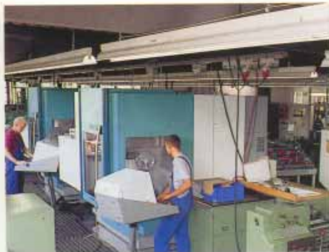
Beim Komplettbearbeiten durch Fräsen/Bohren voll auf Deckel Maho abgefahren: die jüngsten BAZ-Investitionen waren zwei ‚DMU 50 V‘ (links) und je eine ‚DMU 60 P‘ und ‚DMU 80 P‘ - mit allen ist nicht nur 5-Seiten-, sondern auch 5-Achs-Bearbeitung möglich!
